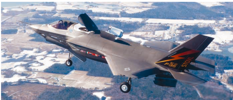
Первый опытный F-35B во время отработки перехода от горизонтального полета к зависанию и вертикальной посадке
